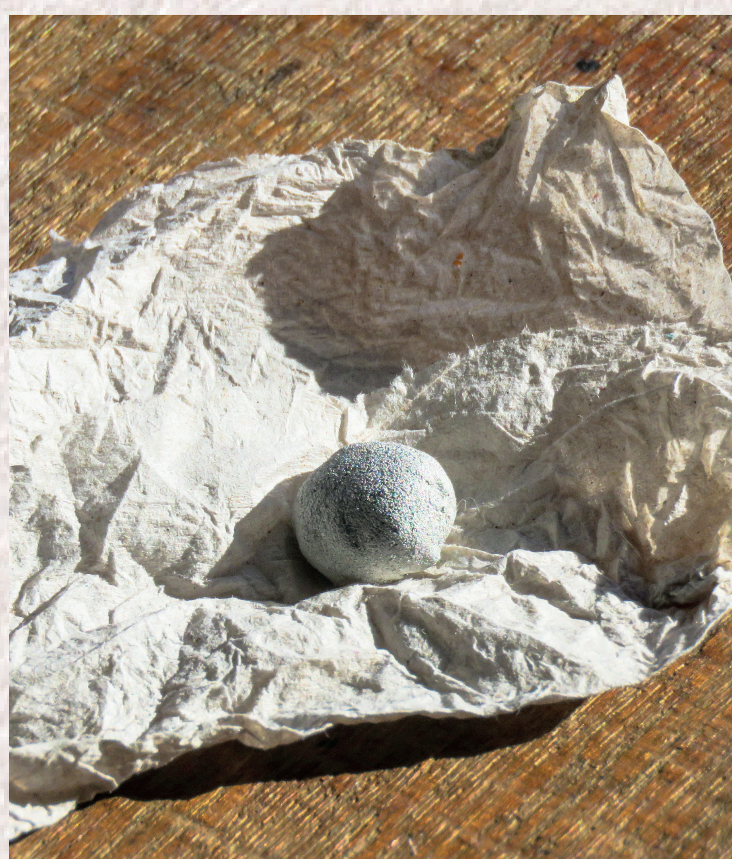
El mercurio se adhiere al oro formando una amalgama (Foto V.A. Vos)
